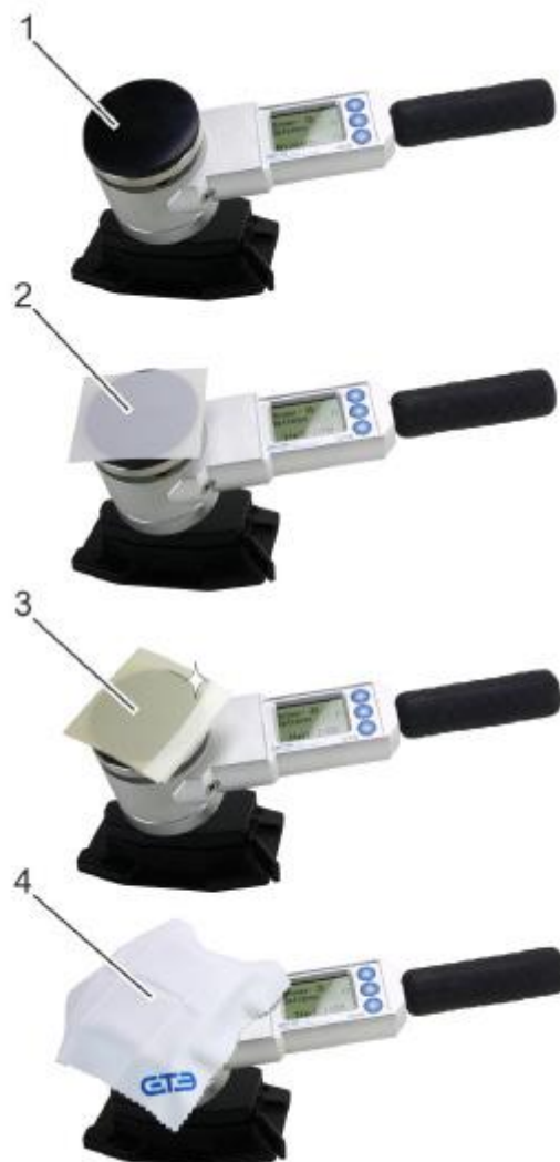
図 10 : 圧力測定フィルムの貼り付け
