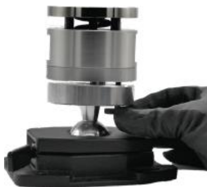
図 19：フォースゲージの固定
